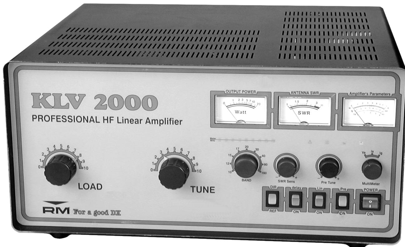
L'amplificatore lineare KLV 2000 è un amplificatore lineare ad alte prestazioni costruito per l'uso con tutti i ricetrasmittitori HF in tutti i modi di trasmissione. Questo amplificatore usa due triodi 572B configurati in classe AB<sub>2</sub> con griglie a massa. Opera in tutte le bande da 160 (1,8 MHz) a 10 (29,5 MHz) metri.
